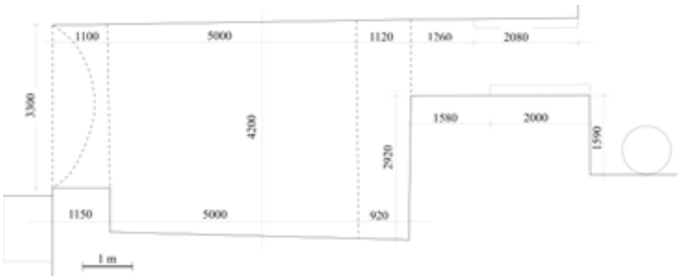
Obr. 5 | Zaměření můstku do Rybářské ulice; mezi bočními pasy oblouků nestejného rozpětí je dodatečně vložená klenba, vpravo přiléhající úsek mohutné zdi je snad pozůstatkem substrukce severozápadního nároží (pozděně) středověké branky do předměstí. Zcela vpravo vyznačen povrchový poklop servisního vstupu.
